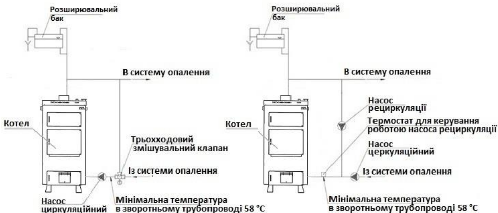
Рис. 4 - Схеми підключення котла до систем опалення
